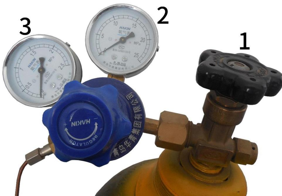
1.总压阀 2.总压表 3.分压表 0.4MPa
