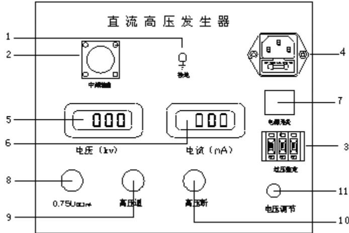
1. 控制箱接地端子：控制箱接地端子与倍压筒接地端子及试品接地联接为一点后再与接地网相连。
