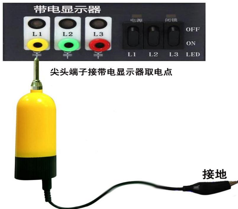
带电显示器核相示意图（图3）
