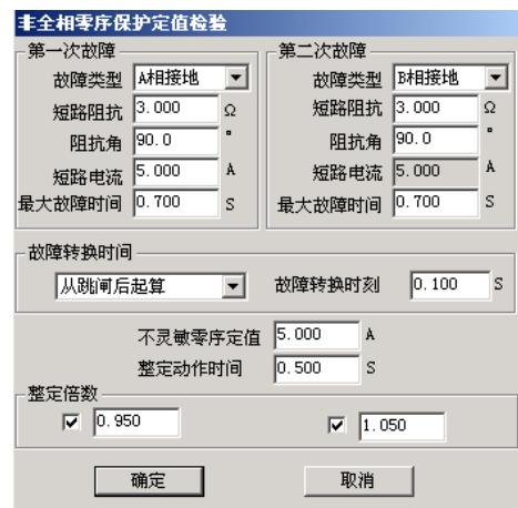
第二次故障的出现时刻可以设定。可选择从第一次跳闸后起算何时出现，也可设定从第一次故障开始时起算何时出现。设定时刻到将自动输出第二次故障。若保护的重合闸功能未退出，则该时刻应设置为重合闸时间未到时。
