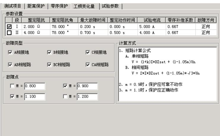
“短路电流”参数应设置得大一些，建议 10~20A，因为短路电流太小，根据上述公式计算出来的电压可能为负值。试验时，“距离保护”压板应投入。
