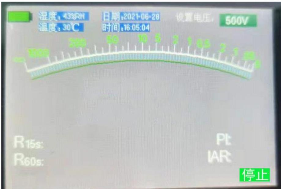
(1) 用“▲、▼”键进行选择合适的输出电压：250V、500V、1000V、2500V
