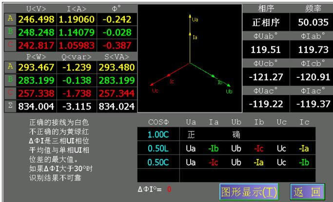
正确的接线用灰色字体显示，不正确的接线用黄、绿、红彩色显示。
