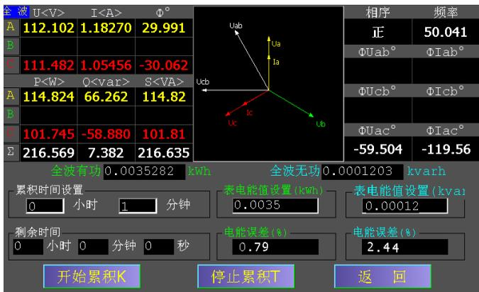
设置累积时间，然后点 “**开始累积(K)**” 图标，显示累积的数值，显示剩余累积时间，点 “**停止累积(T)**” 图标，停止累积，累积时间提前结束。输入表电能值，自动计算误差。点电工数据显示区和相序、相角显示区可以切换显示内容。点 “**返回**” 图标或按返回键，返回主界面。
