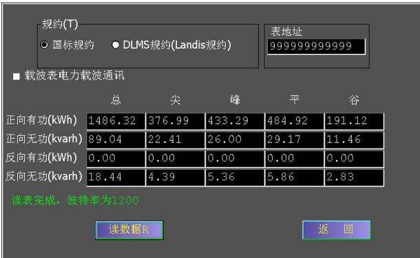
校验仪可以读取支持国标DS645电表的常数、正反向有功、无功的尖、峰、平、谷。
