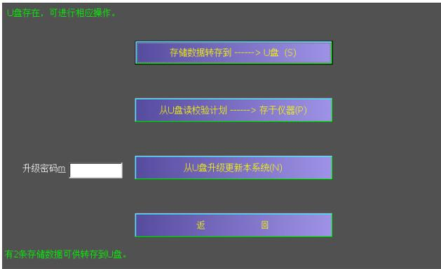
点“**存储数据转存到 ----> U盘 (S)**”图标，数据自动存储到 U 盘上。
