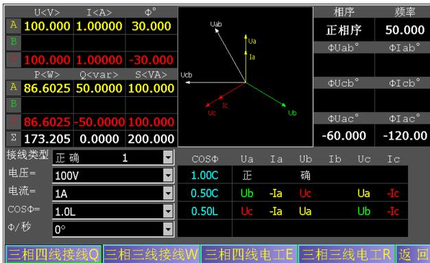
点击参数设置区的下拉框，对接线类型、电压、电流、 $\text{COS } \phi$ 、 $\Delta \phi$ /秒进行更改、设置，设置完后自动开始仿真，仿真结果显示在相应的显示框中。
