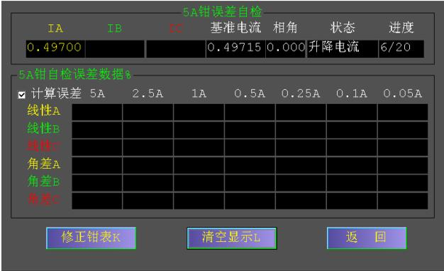
仪器的电压线和电流端子线不要接入任何信号。插上修正环，并将电流钳钳入修正环。
