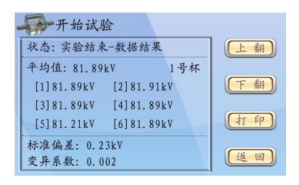
测试从 1 号杯开始, 1 号杯位灯亮, 界面显示"正在升压"、"搅拌、降压以及延时•••••", 按顺序做完 6 个杯位, 再重新从 1 号杯
