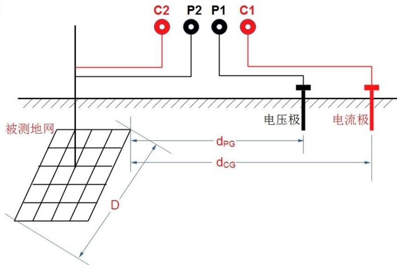
图 5-1 平行布线法测量接线示意图
