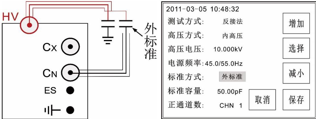
(4)、外高压—外标准—反接法（必须设置外标准容量）
