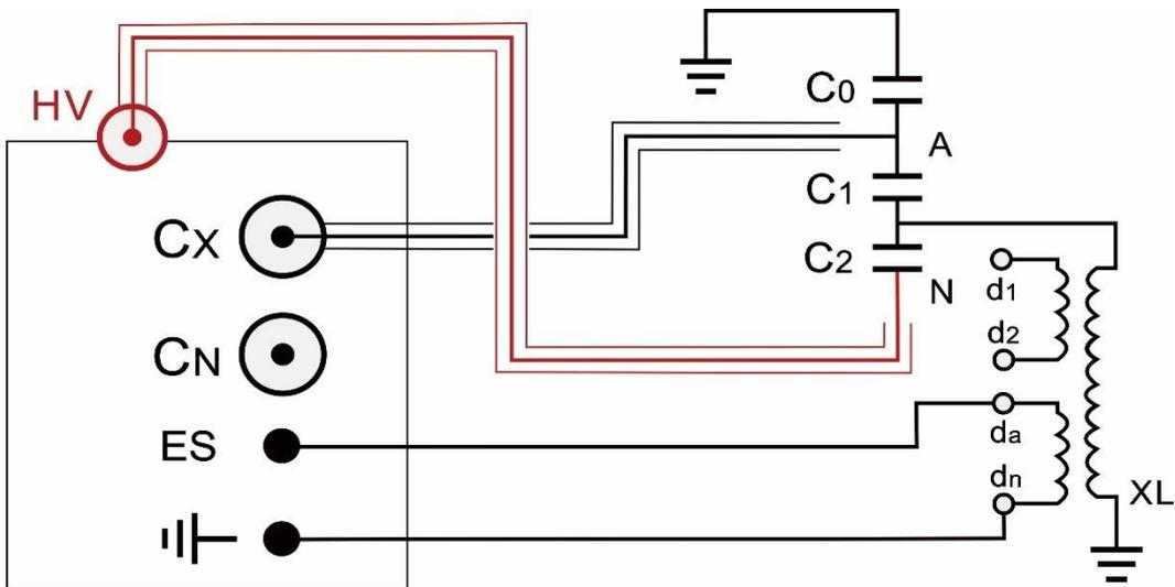
(4)、反接屏蔽法测量 CVT 上端 C0 的电容值和介损测量模式：反接法。电压 $\leq 2kV$
