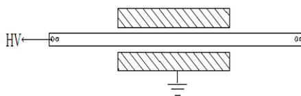
图 6-8 套管接法
