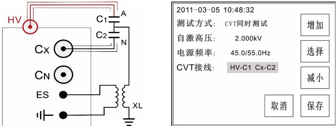
(3)、不拆高压引线测试 CVT 电容值和介损测量模式：CVT 自激法。电压 $\leq 2kV$
