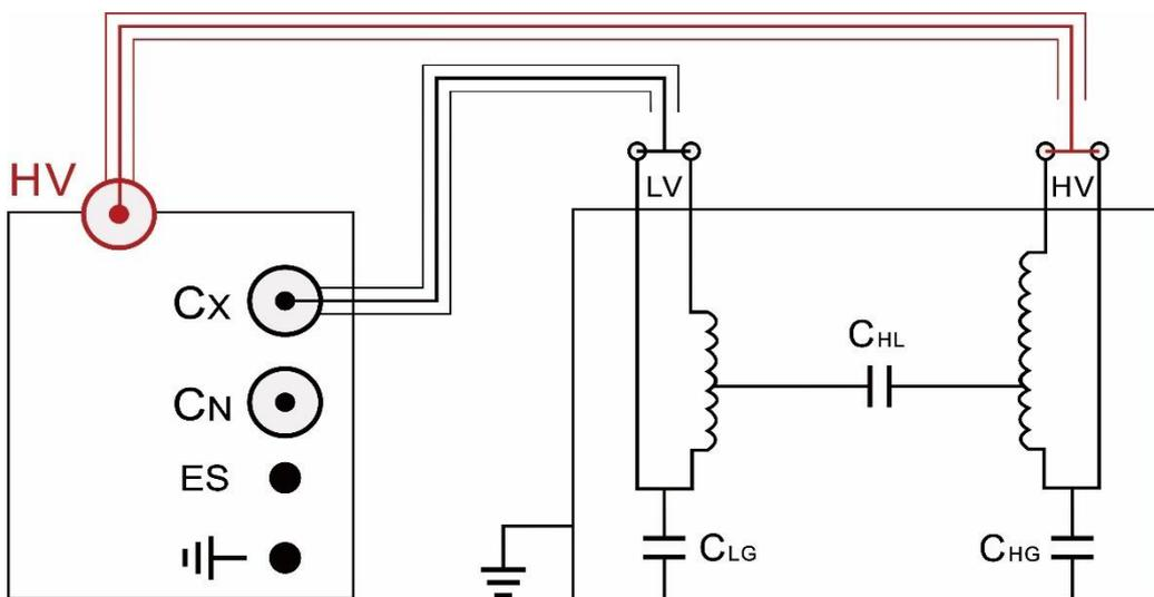
(2)、两绕组变压器  $C_{LG}+C_{LH}$  测试接线
