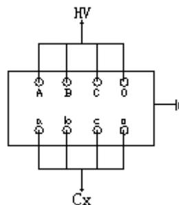
图 6-9 变压器接法
