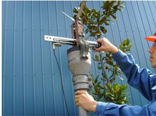
第三步 测量触指压力
