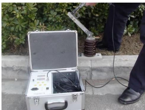
第三步 测量触指压力
