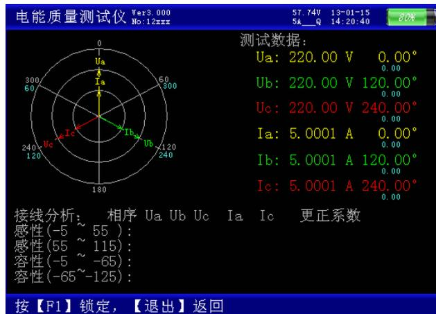
容、感性关系，上图所示为标准阻性负载时接线全部正确情况下的三相四线向量图。按 **F1** 键能将屏幕锁定，便于读数，按 **F2** 继续刷新。**退出**返回主菜单。
