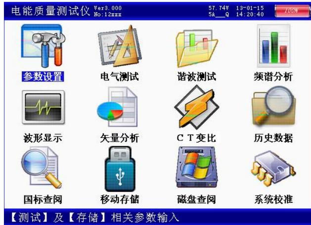
右上角显示出内置充电电池的剩余电量百分比，用户可根据此数值来判断是否需要为仪器充电；电池左侧显示出当前实时的日期和时间；时间左侧显示当前测试仪的电压和电流的测量档位，电压档位的改变为自适应，电流档位的改变需进入“参数设置”选项进行手动设置；屏幕左上角显示仪器名称、仪器编号及软件版本。
