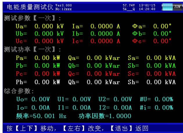
电流  $I_2$ ；电压和电流的不平衡度  $\#U$ 、 $\#i$ ；实测频率、总功率因数。按 F1 键能将当前屏幕锁定，便于读数，按 F2 继续刷新，按 F3 查看一次侧数据，按 F4 切换到二次侧界面。按退出键返回主菜单。
