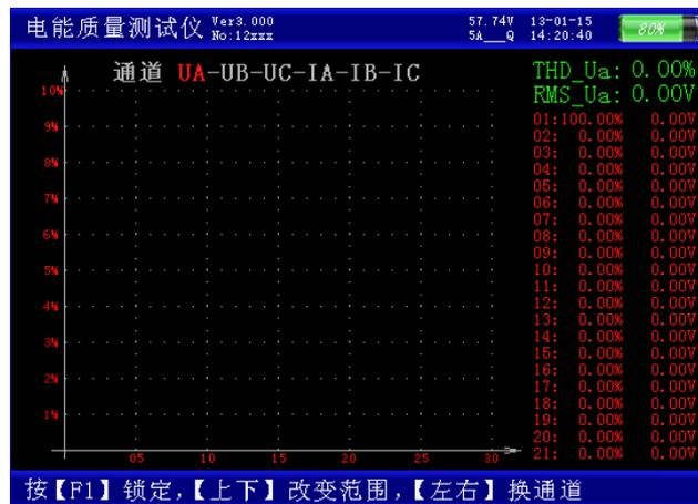
柱状图里只显示到 32 次。UA-UB-UC-IA-IB-IC 提示当前测量通道（可通过 ←、→ 键来改变所选通道），纵坐标刻度 0%-10% 表示各次谐波分量的百分比含量，基波含量始终对应到 100% 刻度（当所有次数的谐波含量都小于 10% 时进行放大显示，即以 10% 做为满刻度；当有一项以上的谐波含量大于 10% 时，以正常刻度显示，即以 100% 做为满刻度），横坐标的指示的是谐波的次数，右侧数值显示总谐波畸变率 THD、有效值和 1—64 次各次谐波的数值（用 ↑、↓ 键来翻页）。无失真的信号应显示第一次谐波（基波）。测试时用 U<sub>a</sub>、U<sub>b</sub>、U<sub>c</sub> 三个电压通道和 I<sub>a</sub>、I<sub>b</sub>、I<sub>c</sub> 三个电流通道进行测量。
