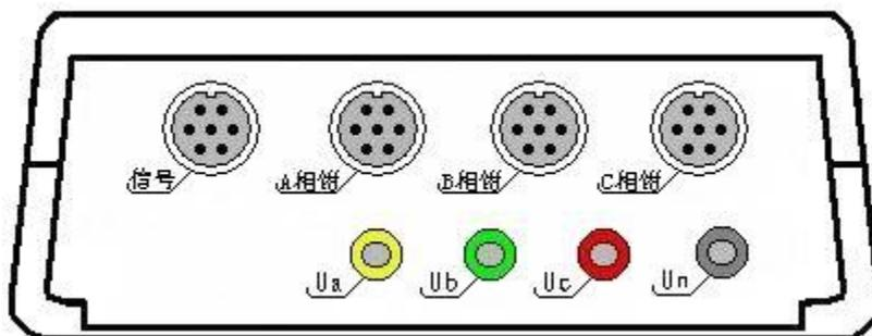
包括：电压输入端子  $U_A$ 、 $U_B$ 、 $U_C$ 、 $U_N$ ；钳形电流互感器接口（A相钳、B相钳、C相钳）；信号接口（保留功能）。
