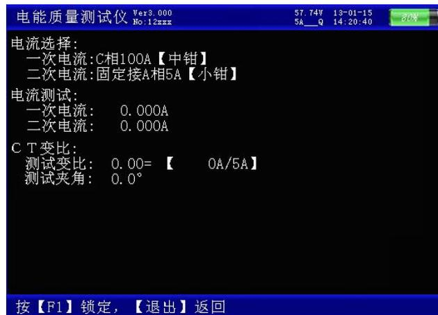
在参数设置中应按照一次电流所使用的钳表量程来设置。
