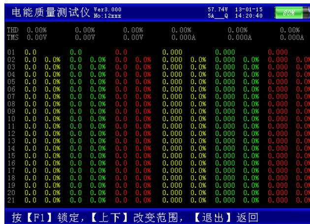
THD 为各相的电压或电流波形畸变率（即总谐波失真度），RMS 为各相的电压或电流有效值，01 次为基波电压或电流（用实际幅值表示），以下依次为其它各次谐波的数值，以有效值形式和基波的百分比两种形式表示，以表格的形式显示 1-63 次谐波。可通过 ↑、↓ 键来切换（01—21）次、（22—42）次（43—63）次谐波含量的表格。
