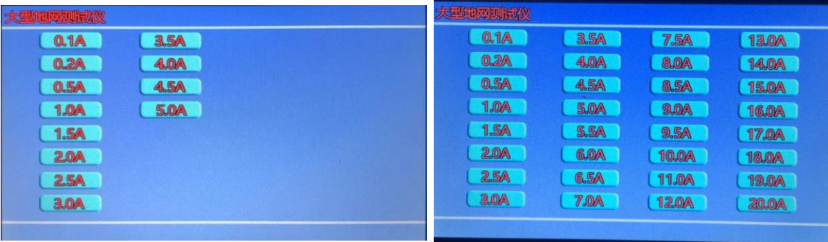
图 8 测试电流选择（常规仅到 5A，20A 的需要定制）
