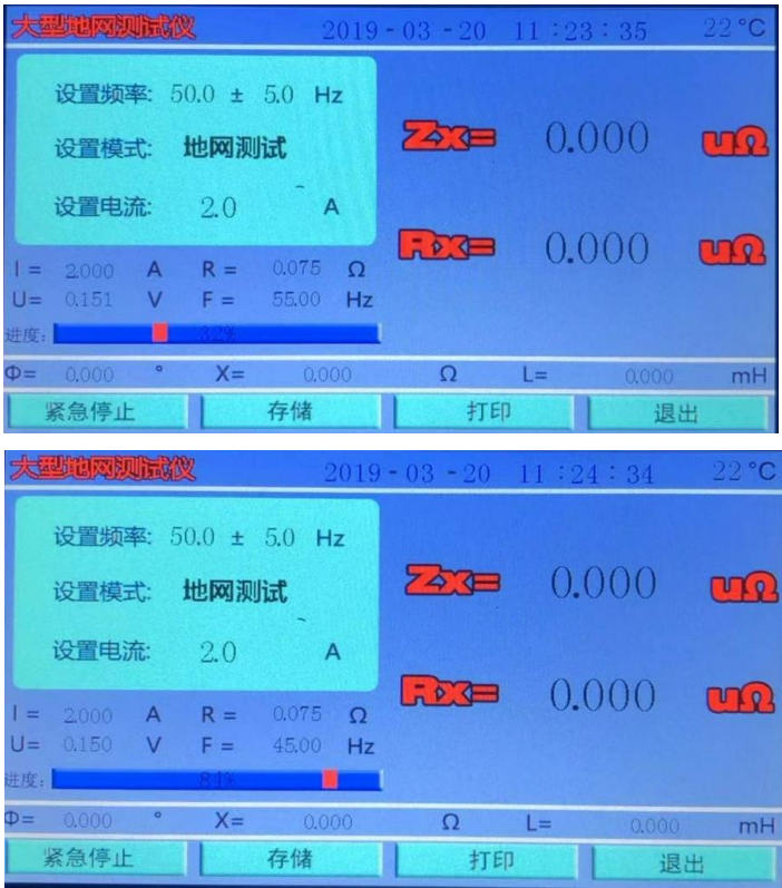
图 11 地网测试界面
