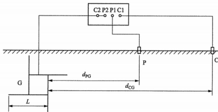
G—被测杆塔接地装置；C—电流极；P—电位极；L—杆塔接地装置的最大射线长度；
