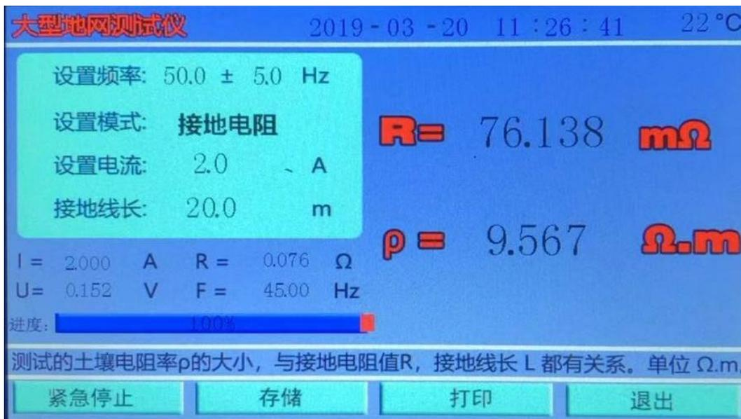
图 16 接地电阻测试结果界面
