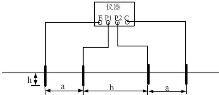
图12 四极法测量土壤电阻率接线图
