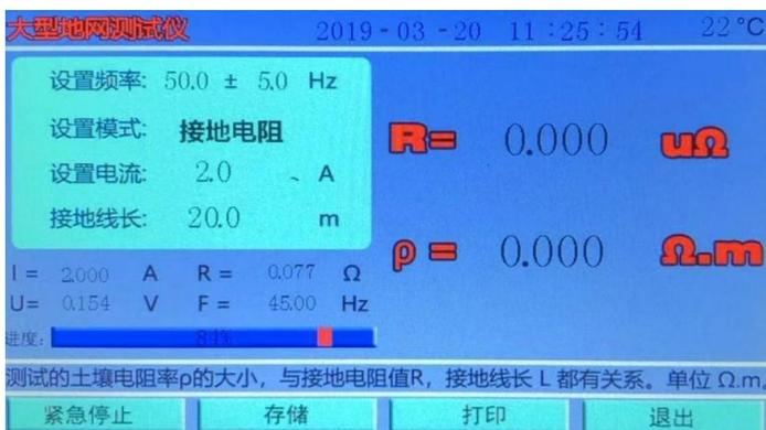
图 15 接地电阻测试界面
