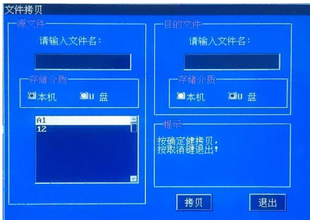
注：在此功能模块下完成操作后（特别是删除操作）必须按返回键返回上一级菜单，不能直接关闭仪器，否则会破坏记录链表。
