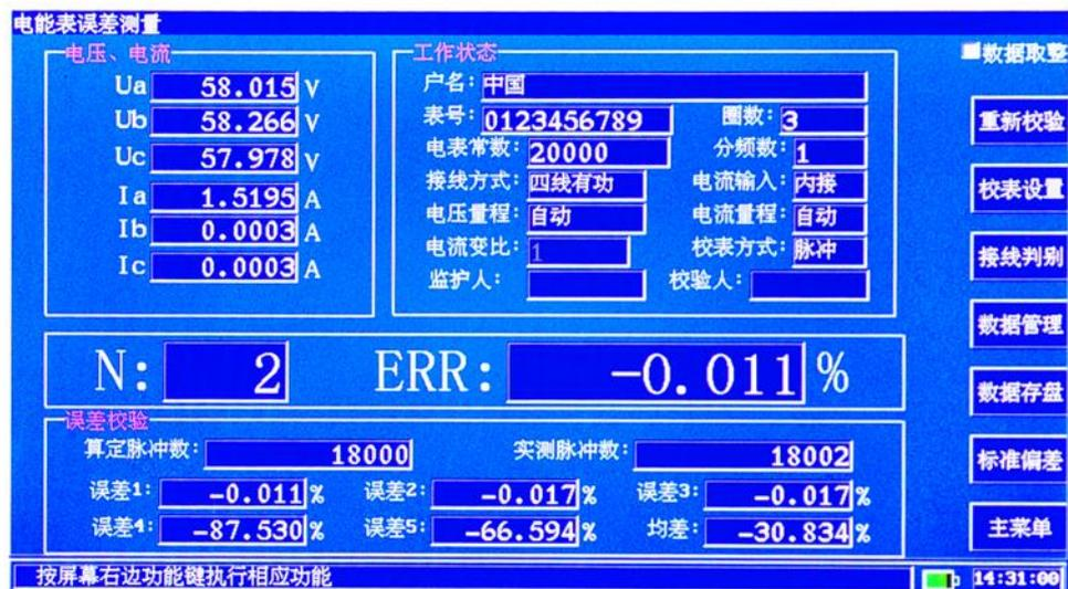
图 17 (1): 电能表误差测量 (0.05 级)
