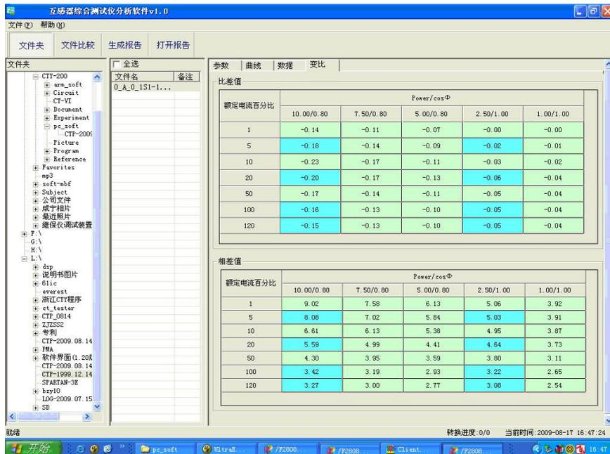
图 3.4 PC 机操作软件变比界面
