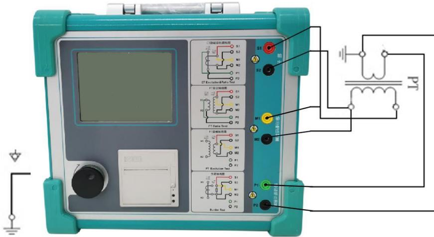
图 2.8 PT 变比、极性试验接线方式
