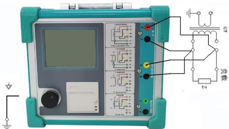
图 2.2 CT 二次负荷试验接线方式
