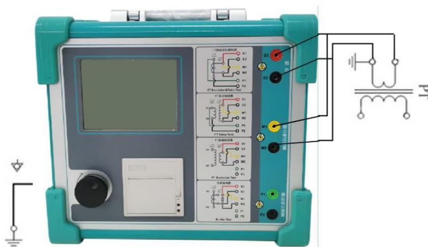
图 2.7 PT 直阻、励磁试验接线方式
